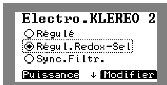
Figure 60. Réglage de la puissance de fonctionnement de l'électrolyseur
