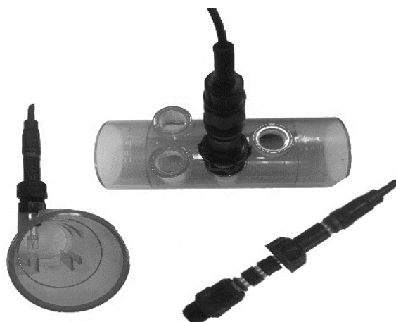
Figure 17. montage des portes-sondes et de la sonde redox
