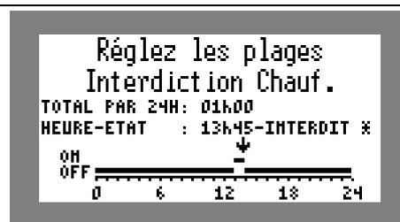
Figure 7. Configuration de l'interdiction chauffage
