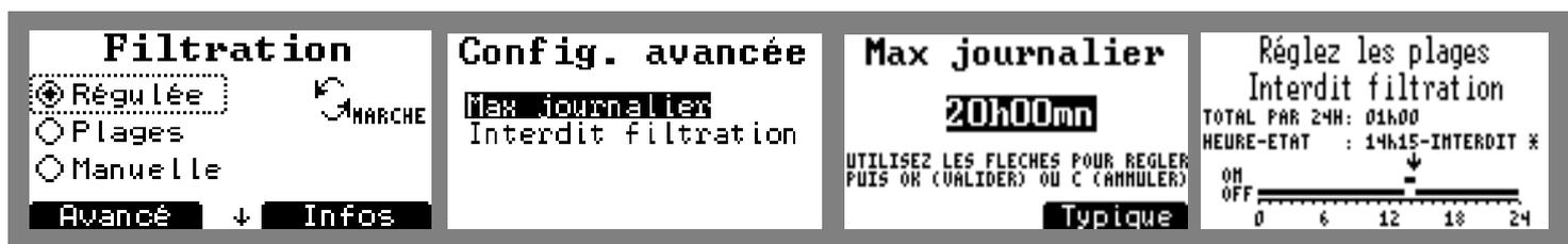
Figure 2. Ecrans de programmation de la filtration en mode régulée
