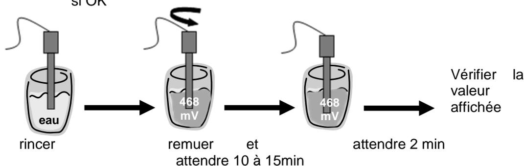
Figure 9. Vérification de la sonde Redox
