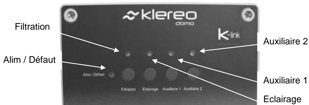
Figure 1. Les voyants de la centrale
