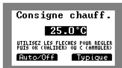
Figure 9. Ecran de réglage de la consigne chauffage
