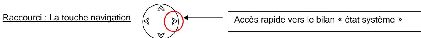
Lorsque l'on appuie sur la flèche de droite, un bilan de l'état du système s'affiche sur l'écran Klereo. Cela permet d'obtenir un résumé des paramétrages de la filtration, du chauffage et du traitement (pH et désinfectant)
