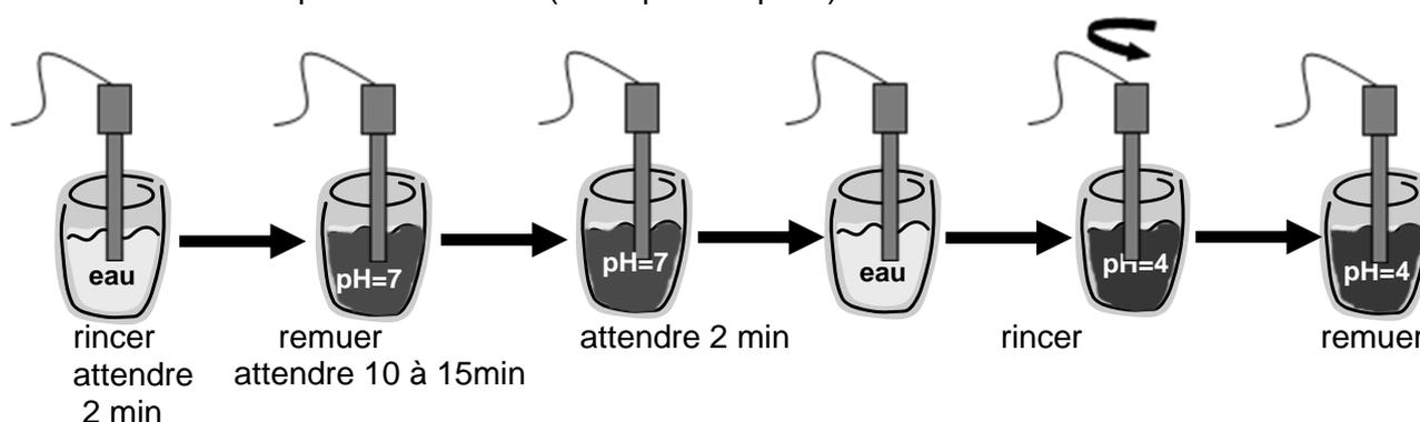
Figure 11. Calibration de la sonde pH
