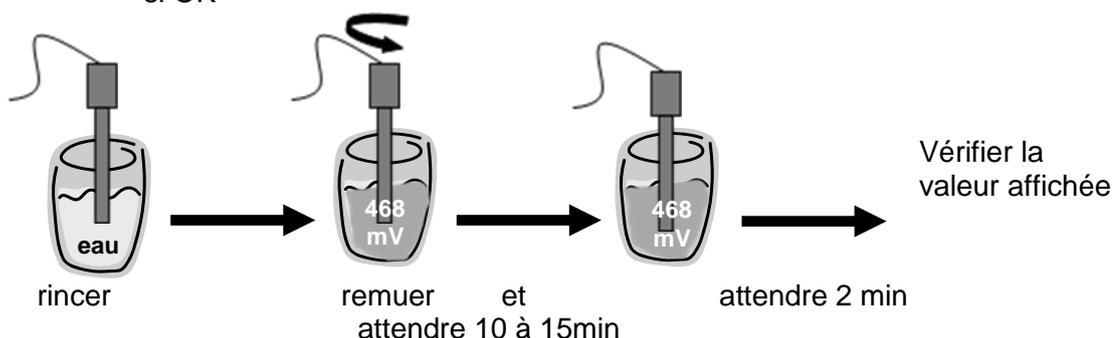
Figure 12. Vérification de la sonde Redox
